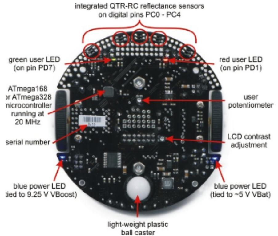
El Pololu 3pi robot es una plataforma móvil de alto rendimiento con dos micro motores de metal, cinco sensores de reflectancia, un LCD 8 x 2 caracteres, un timbre y tres pulsadores, todos conectados a un microcontrolador ATmega328 programable en C. Capaz de alcanzar velocidades superiores a 3 metros por segundo, el 3pi es un primer robot para los principiantes ambiciosos y un segundo robot perfecto para aquellos que buscan pasar de los robots para principiantes no programables o más lento.
